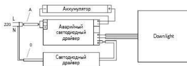
Рис. 2 Схема подключения аварийного светильника
