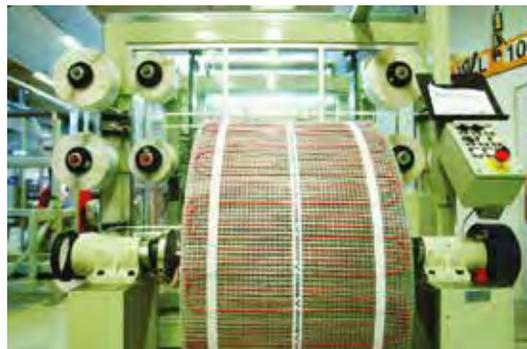
Автоматическая линия по производству нагревательных матов
