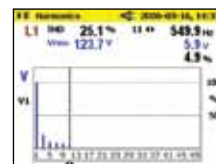
Гармоники напряжения и тока до 50-й включительно.
