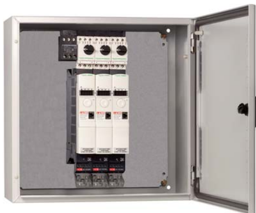
Пример прямого крепления автоматических выключателей GV2 к преобразователям частоты ATV 32 в шкафу: автоматические выключатели GV2 L + принадлежности GV2 454 и GV2 G05 + преобразователи частоты ATV 32HU15N4
