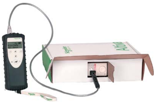
Конфигурирование преобразователя частоты Altivar 32 в заводской упаковке: мультизагрузчик WW3 A8 121 + кабель WW3 A8 126
