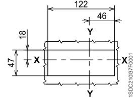
С фланцем и лицевой панелью автоматического выключателя заподлицо с дверцей (3-4 ПОЛЮСА)
