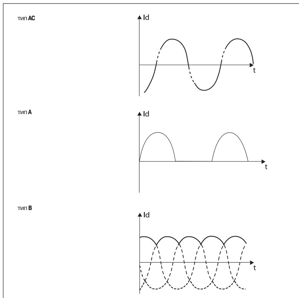
При наличии электроаппаратуры с электронными компонентами (компьютеры, принтеры, факсы и т.д.) ток утечки на землю может быть не синусоидальным, а пульсирующим однонаправленным постоянным током. В этих случаях необходимо использовать расцепитель токов утечки на землю класса A.
