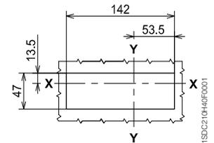
С фланцем и лицевой панелью автоматического выключателя заподлицо с дверцей (3-4 ПОЛЮСА)
