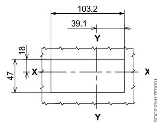
Без фланца и с выступающей из дверцы щита лицевой панелью автоматического выключателя (4 ПОЛЮСА)
