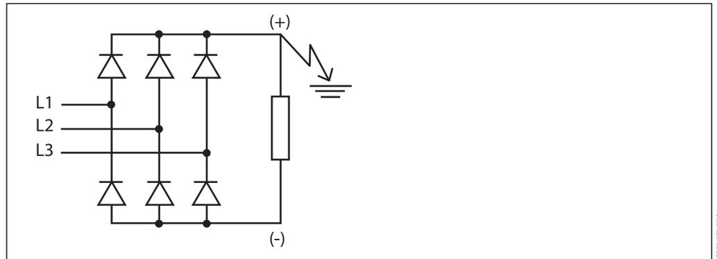
Фактически, в случае возникновения замыкания на землю в секции установки с питанием постоянным током, ток аварии с выраженными “постоянными” характеристиками протекает практически через секции с переменным током.
