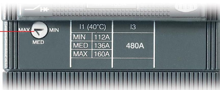
TMD = термомагнитный расцепитель защиты с регулируемым тепловым порогом ( $I_1 = 0,7...1 \times I_n$ ) и фиксированным магнитным порогом ( $I_3 = 10 \times I_n$ ).
