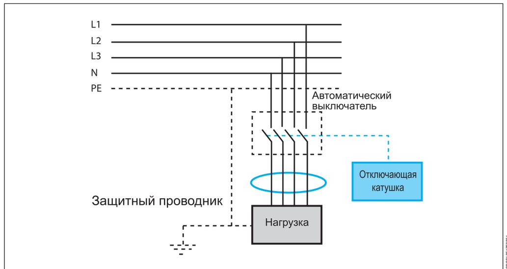
Принцип работы расцепителя токов утечки на землю делает его пригодным для распределительных систем TT, IT (ей следует уделить особое внимание) и TN-S, но не для систем TN-C. Фактически, в этих системах нейтраль также используется в качестве защитного проводника, что делает невозможным определение дифференциального тока, даже если бы нейтраль (называемая PEN в этих распределительных системах) проходила через тороид, так как векторная сумма токов была бы всегда равной нулю.
