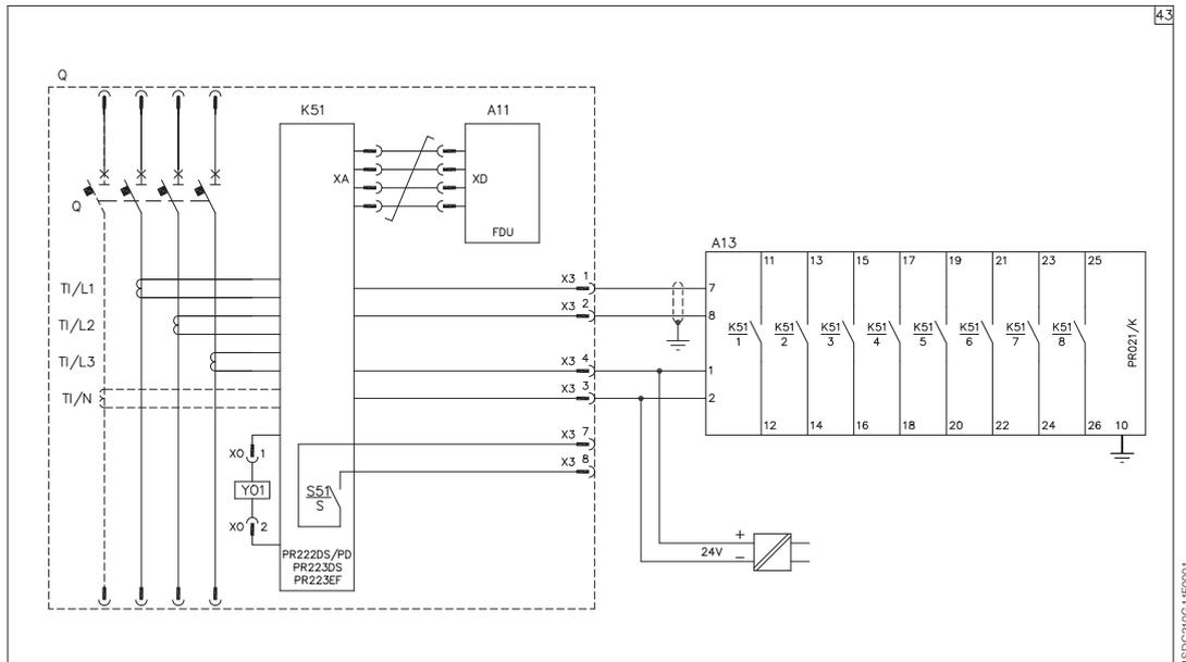
**Электронный расцепитель защиты PR222DS/PD, PR223DS или PR223EF с подключенными дополнительными контактами AUX-E**
