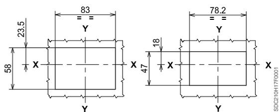
С фланцем и лицевой панелью автоматического выключателя заподлицо с дверцей щита (3-4 ПОЛЮСА)
