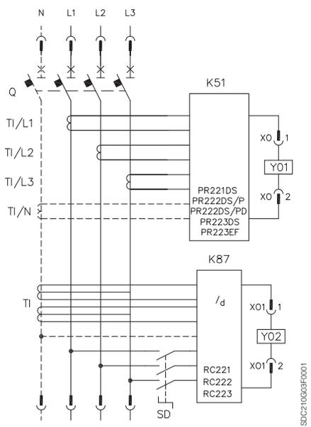
Трехполюсный или четырехполюсный автоматический выключатель с электронным распределителем защиты PR221DS, PR222DS/P или PR222DS/ PD и распределителем защиты дифференциального тока RC221, RC222 или RC223 (только для четырехполюсных Т4, Т5 и Т6)
