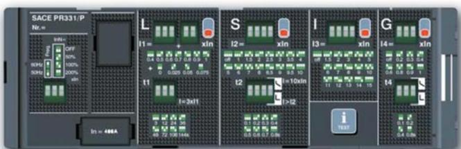
Расцепители защиты PR231 и PR232, с DIP-переключателями для регулировки порогов срабатывания каждой защитной функции снабжены светодиодами, сигнализирующими о срабатывании защиты: это означает, что всегда может быть выявлена причина срабатывания автоматического выключателя.
