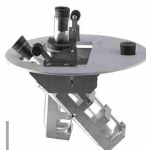
Комплект приспособлений для ГОСТ 20287 метод Б
