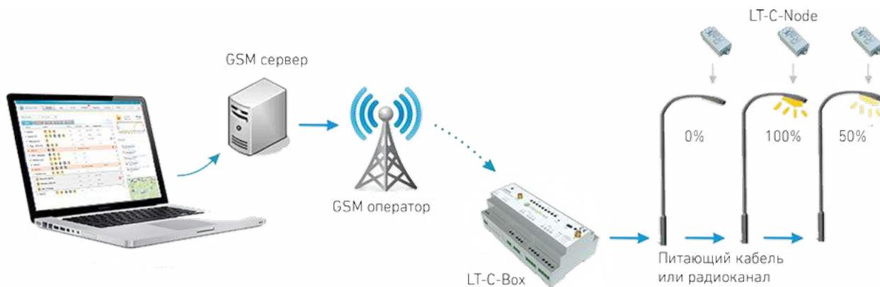
Автоматизированная система управления LT Citylight является простым, и, в то же время, комплексным решением для мониторинга и управления наружным и промышленным освещением. Управление светильниками в системе осуществляется по протоколу PLC по питающему кабелю без необходимости прокладки дополнительных проводников или установки GSM-модемов в каждый светильник. Установка данной системы достаточно проста и не требует привлечения узких специалистов. Применение LT-Citylight позволяет экономить до 50
