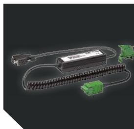
Интеллектуальное устройство для настройки. Клемная колодка данного устройства устанавливается в ШУНО на DIN-рейку после чего при помощи компьютера может быть осуществлена загрузка сценариев во все подключенные к линии контроллеры светильников.
