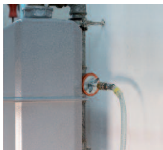
Рис. testo 324 быстро подсоединяется к газовому трубопроводу с помощью практичного разъема для подключения шланга.
